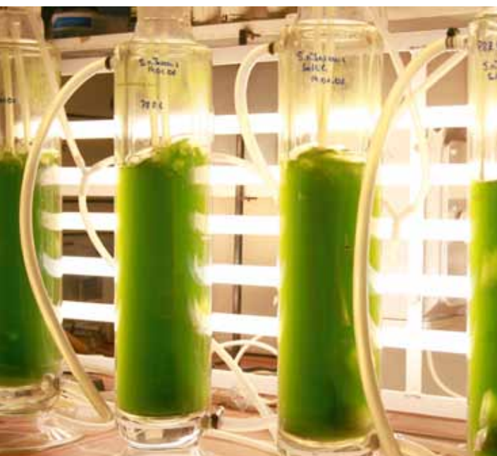
Mikroalgen im Blasensäulenreaktor
